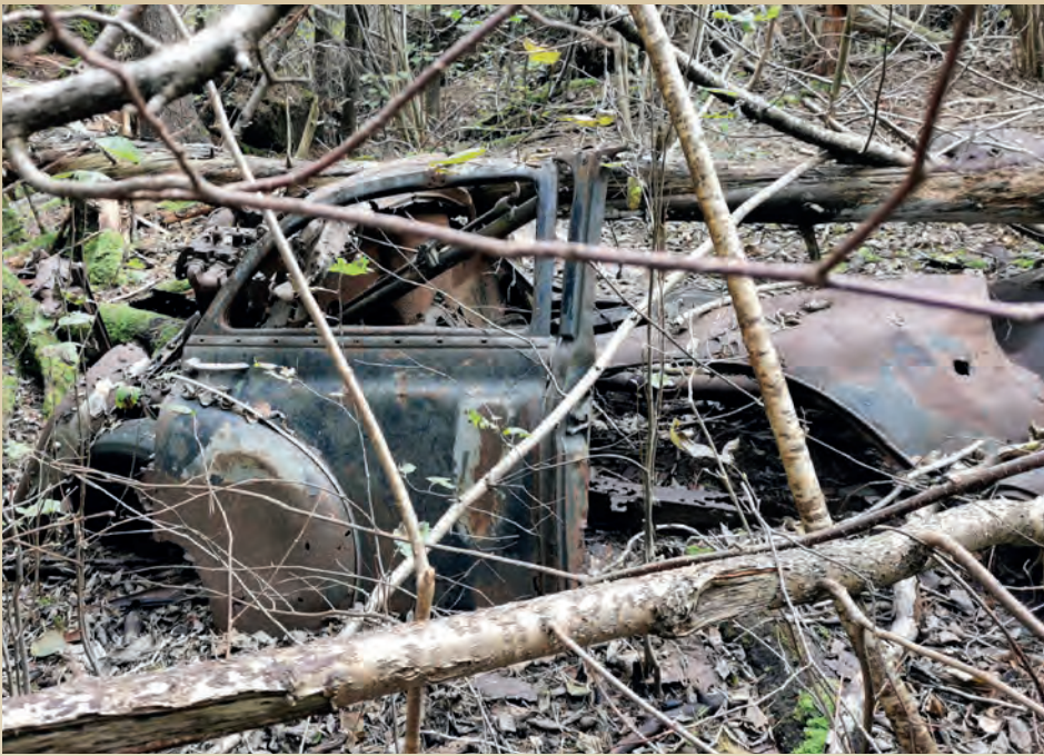
Fra Heistad: Høyre bakdør og B-stolpen er kanskje det mest åpenbare beviset på hva slags bil dette har vært. 49 og 50 Chevrolet hadde kromlister som fulgte bakskjermen fra steinsprutbeskyttelsen i forkant og helt bak til bakstøtfangeren. Bak døra skimter vi rattstammen med rattgrioverføring i overkant.
